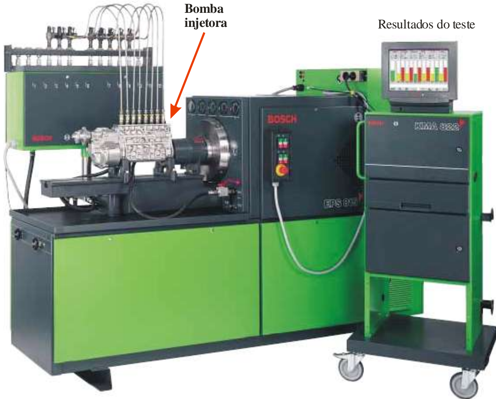
Figura 11. Bancada Bosch para regulagem eletrônica de bombas injetoras.
